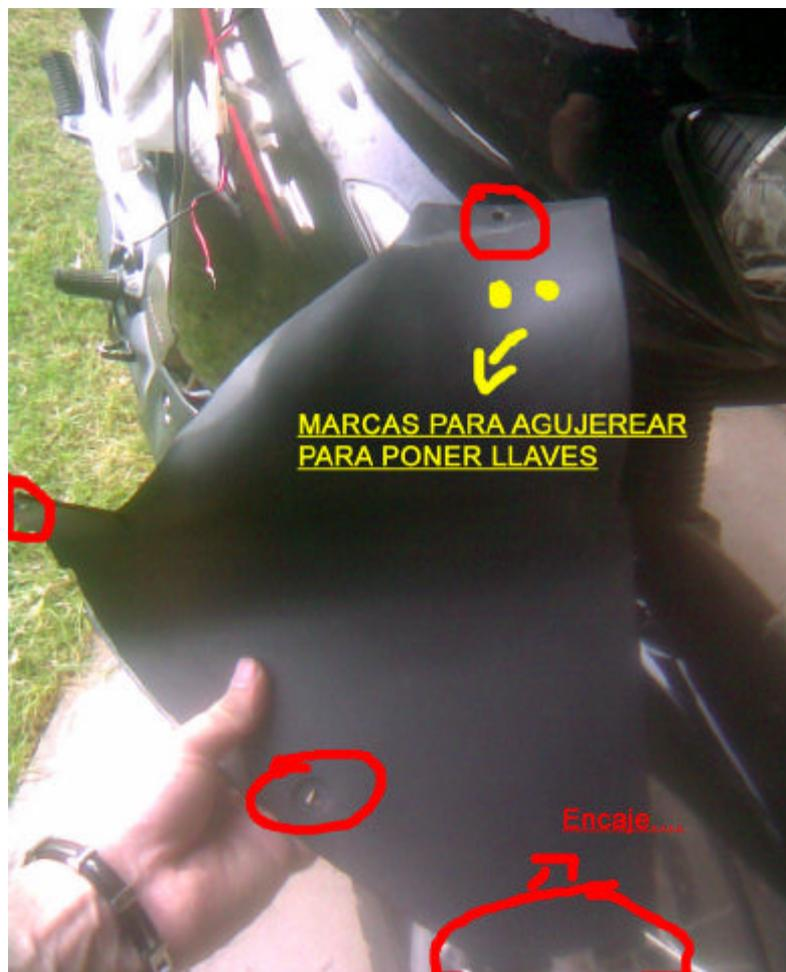
Bueno.... Una ves q ya tenemos la llave colocada... (obviamente que la hemos conectada al circuito!! y soldada por detras al cable!!) Vamos a sujetar los cables de alimentacion del calienta puños. No hace falta decir que la 2da capa de barniz tiene que estar seca.... Y todo listo para colocar los puños de goma arriba, pero eso al final. Ahora, a sujetar esos cables ya mencionados.
