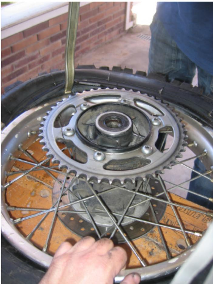
Una vez introducido todo el neumático, hay que volver a enllantar éste en la llanta. Para ello, se hincha el neumático hasta una presión de unos 4 kg (o hasta que veamos que ya ha enllantado completamente) y luego se le ajusta a su presión adecuada.
