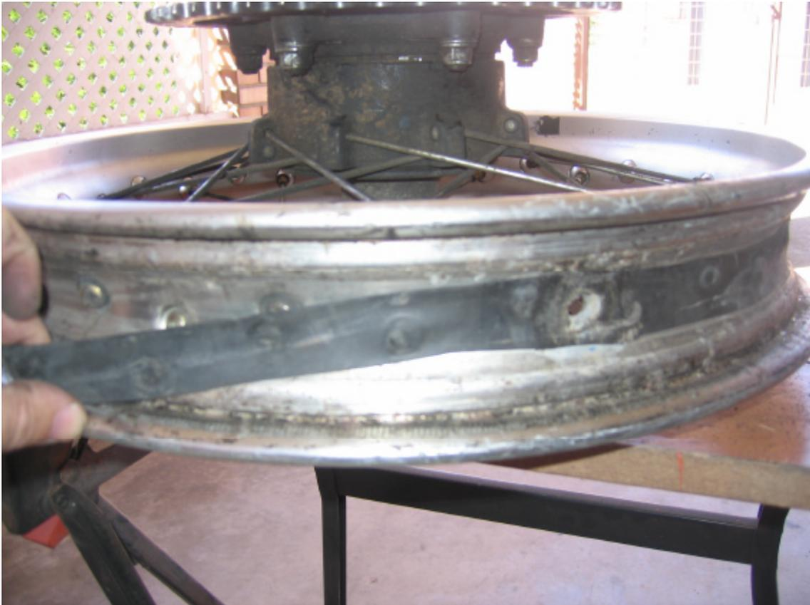
En caso de cambiar la cámara, hay que sacar la cámara completa, incluida la válvula. Para sacar la válvula no hay más que quitar la tuerca que la sujeta a la llanta y extraerla junto con la cámara.
