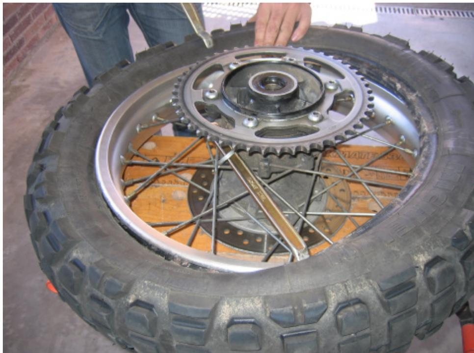
Con dos desmontables es suficiente para sacar la cubierta, pero con tres es más fácil ya que dejas uno fijo y con los otros dos vas sacando la cubierta.
