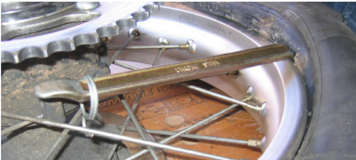
Ahora, con los otros dos desmontables, vamos introduciéndolos entre la llanta y cubierta y haciendo palanca cada pocos cms. alrededor de la cubierta hasta que saquemos todo el aro interior de la cubierta. Ojo, hay que tener mucho cuidado siempre de no pellizcar la cámara.
