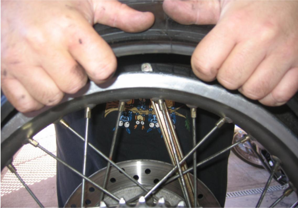
Fijaos bien que el desmontable está pillando el neumático por detrás, dejándonos toda la garganta diáfana para poder meter bien la válvula. Éste se sujeta con el anillo a un radio o directamente enganchado en el disco del freno (como en este caso). Una vez introducida la válvula en su sitio, le ponemos su tuerca y quitamos este desmontable para facilitar la inserción del resto de la cámara.
