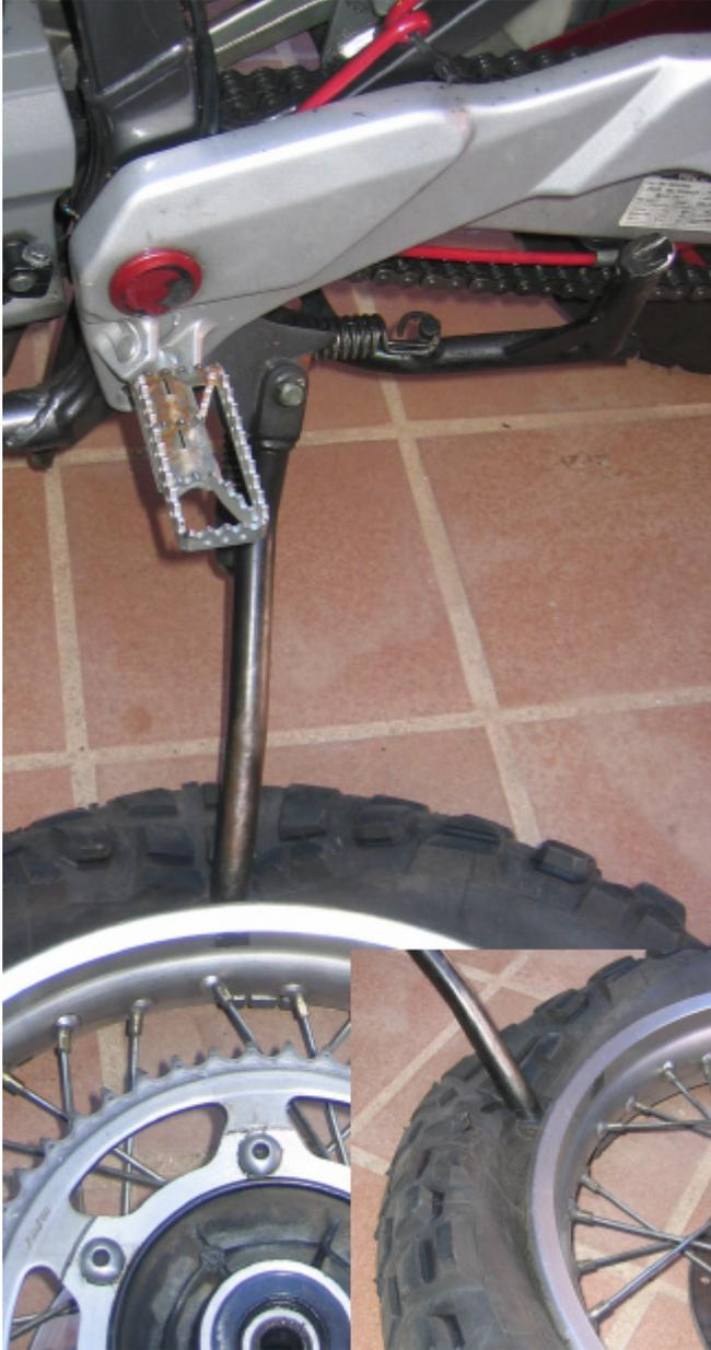
**El desllantado** consiste en sacar el aro interior del neumático de lo que se llama el hombro de la llanta que no es más que el alojamiento interno más exterior de la llanta. Pues bien, en esa ubicación hay unas estrías metálicas que tienen como misión impedir que el neumático gire alrededor de la llanta. Esta operación de desllantado se puede complicar bastante ya que, con el calor, la goma del neumático se pega fuertemente a estas estrías y a veces es difícil despegarla.
