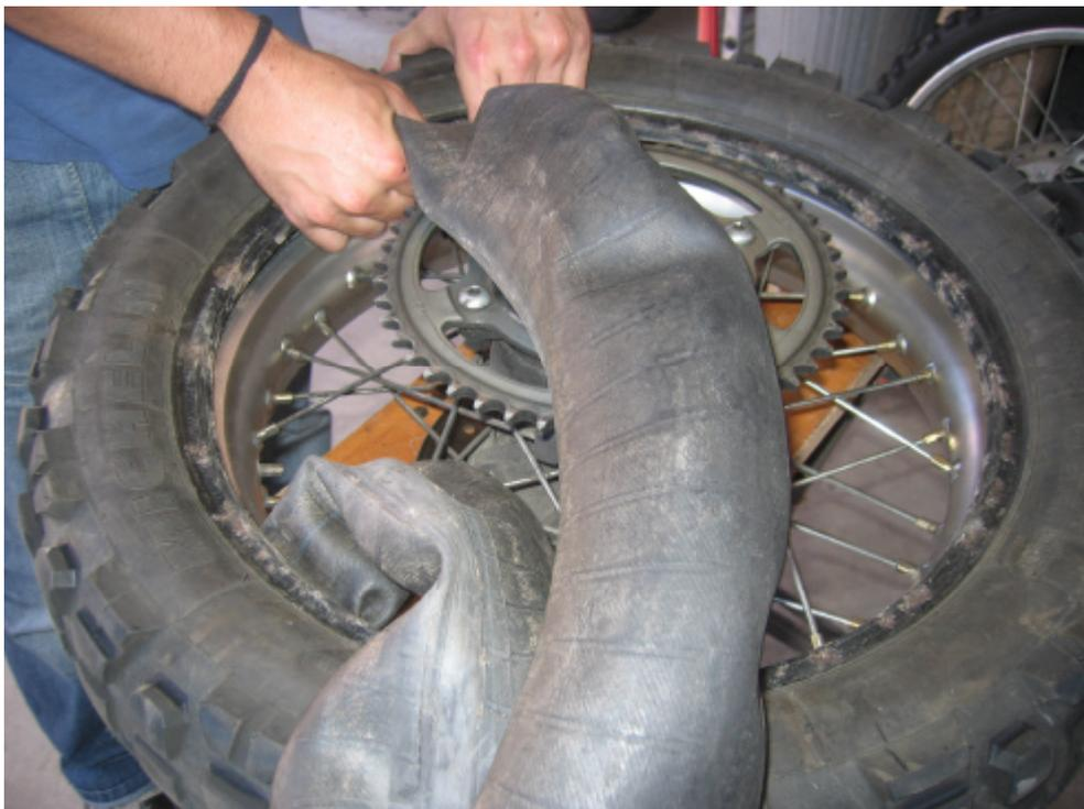
Normalmente, si es un pinchazo limpio y no a afectado a la válvula, no será necesario sacar la cámara del todo, simplemente sacaremos la parte de la cámara donde esté localizado el pinchazo y procederemos a repararlo.
