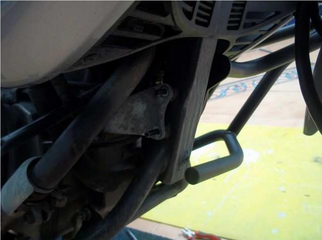
Después la derecha y ponemos las tuercas, sin olvidar meter antes el tubito de unión y la tuerca del tornillo del eje del caballete.
