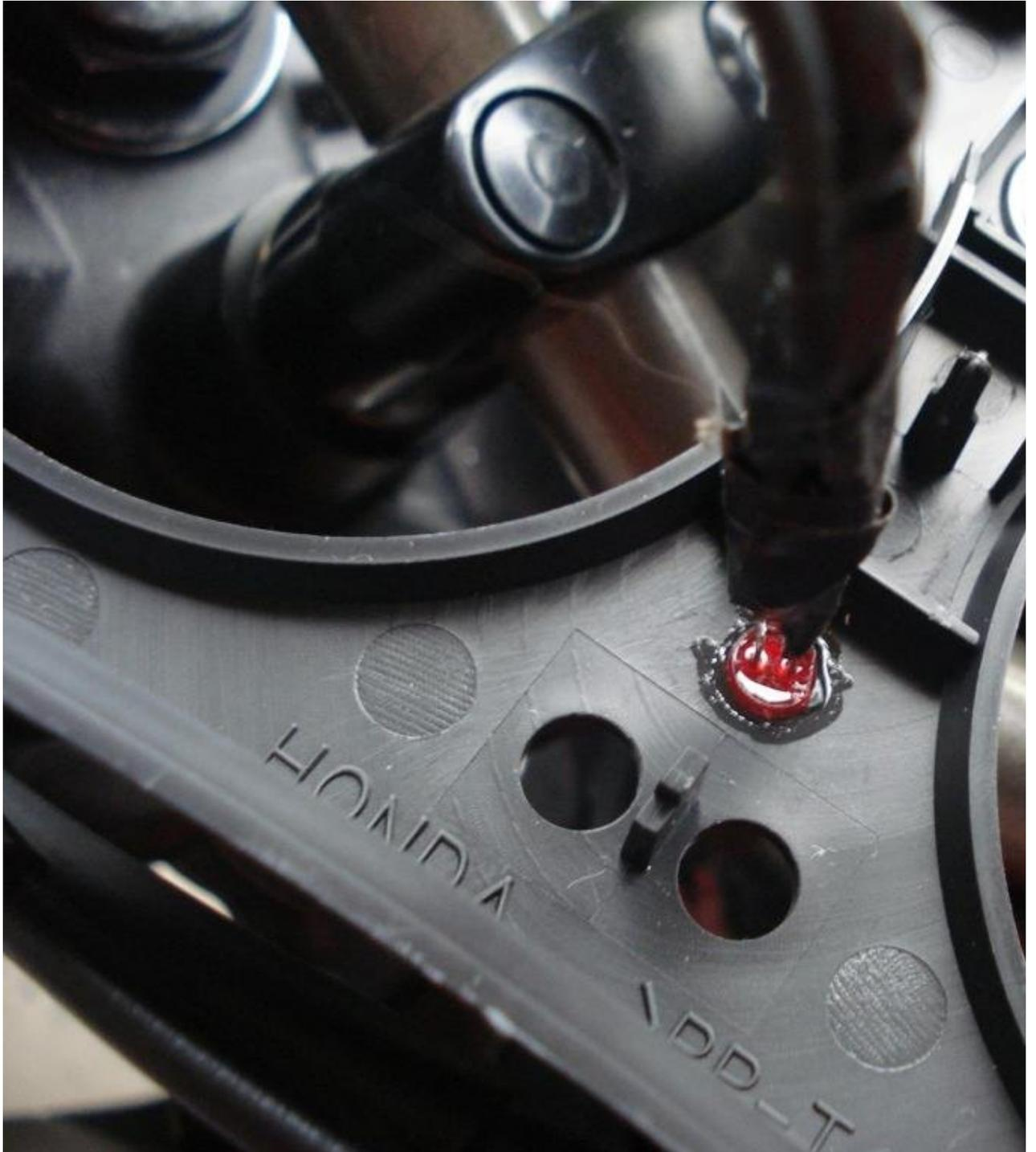
**Una ves q pasamos el cable por el agujero del tablero, de abajo, calzamos de nuevo la plaqueta con los botones para configurar el reloj, y luego ponemos el plastico negro sobre el tablero...**
