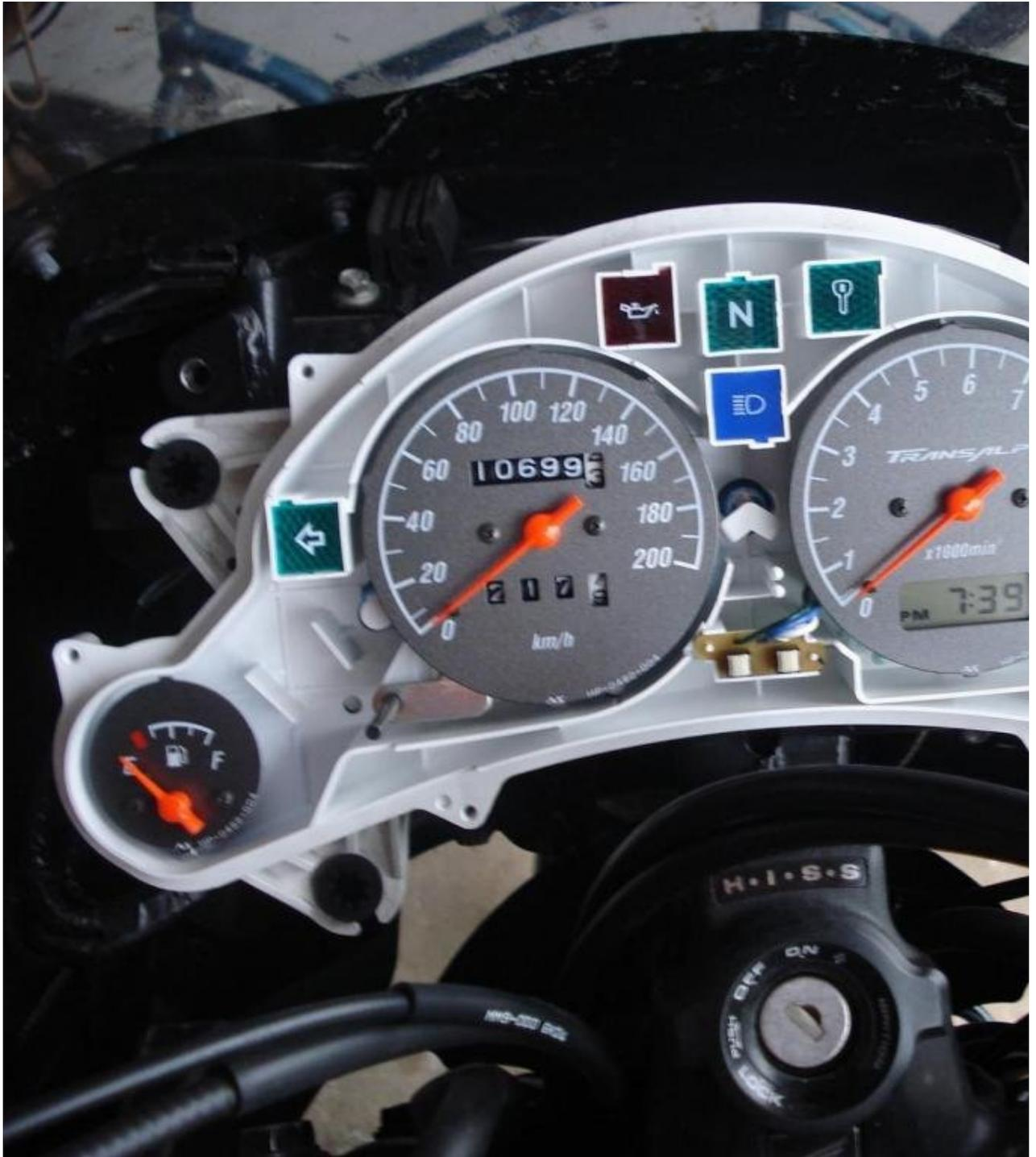
**Ahora levantar la pequeña plaqueta con dos botones que es para configurar el reloj, se levanta con los dedos, no hay nada de complicado. Por ahí va a pasar el cable del led próximamente.....**
