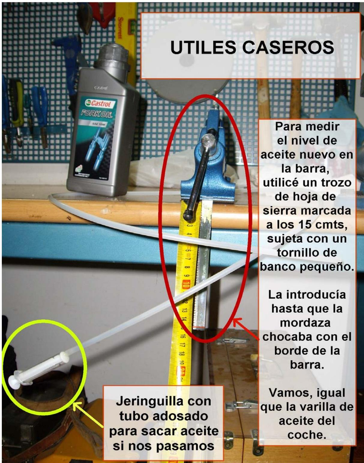
Otra cosita importante es que una vez echemos el aceite nuevo a la barra, debemos, **antes de medir el nivel**, volver a bombear varias veces para que el aceite penetre completamente a la parte baja de la horquilla.
