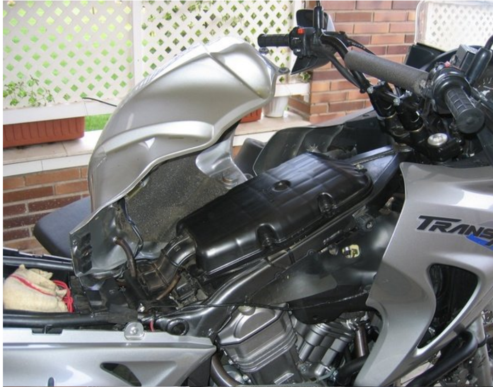
VISTA DEL FILTRO DEL AIRE
