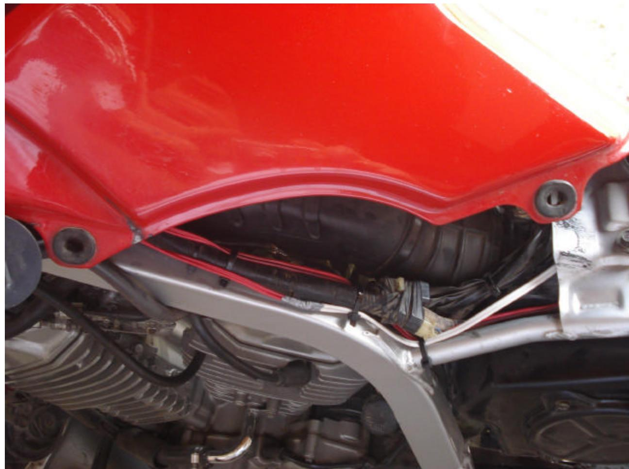
**Despues armar todo tranquilamente... Volver a enchufar la ficha en el rele.... No dejar cables pelados....**
