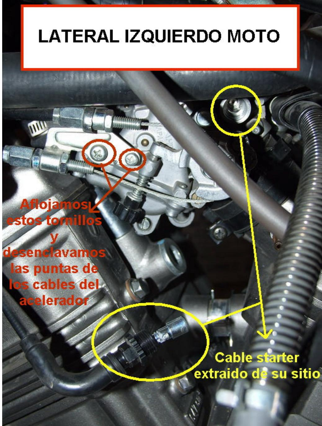
Venga que ya está casi todo desmontado, solo nos queda aflojar las abrazaderas superiores de las toberas de admisión de los cilindros:
