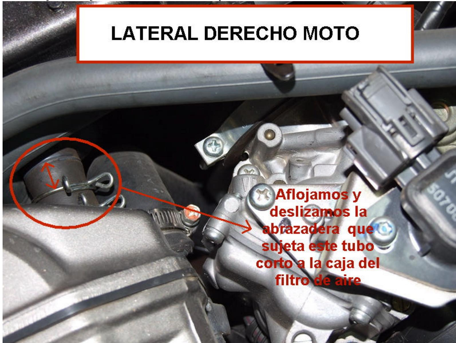
Ala ya tenemos los 4 tubos sueltos, es el momento de aflojar las abrazaderas de las toberas de entrada de aire a los carburadores:
