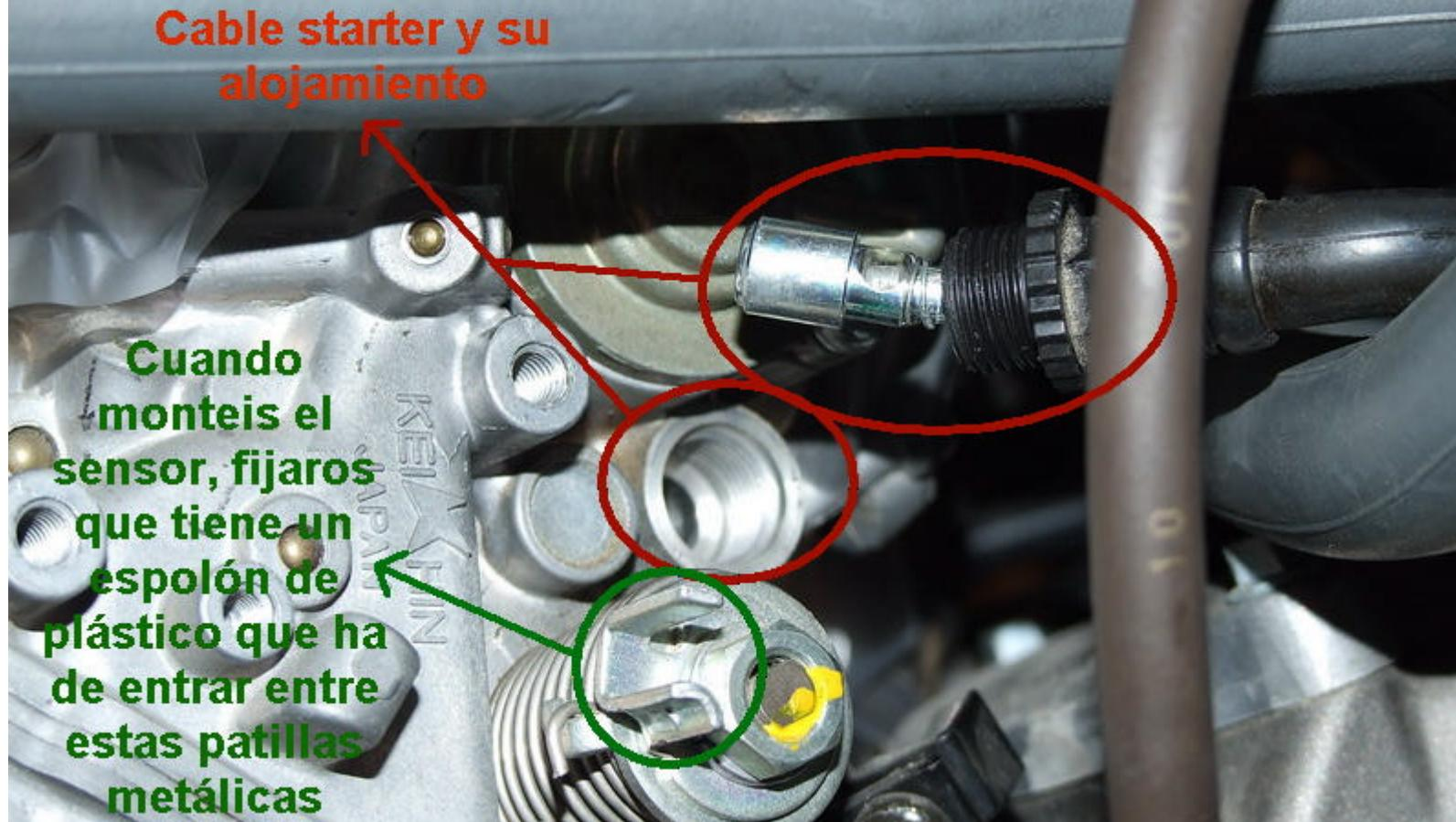
Como habeis visto en las fotos se trataba de eso, de sacar el cable del starter (el del codo de goma y la rosca de plástico negro) de este lado del carburador.
