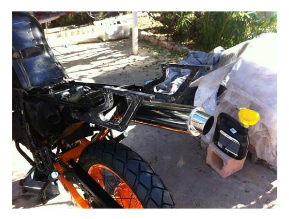
Usando el portabultos original como soporte, he empezado a adaptarlo para colocar el portabultos de la 650, que además lleva asas para el pasajero (una carencia notable en este modelo) y permite la instalación de los soportes de alforjas de Givi, que me resultan más atractivos que las maletas y así combino la estética algo más deportiva con el aspecto practico de llevar equipaje cuando voy de viaje.
