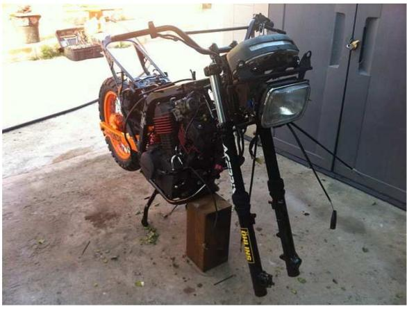
Empezamos la puesta en marcha, filtros de aceite y aire nuevos, aceite (Castrol 20W50), liquido de limpieza de radiadores (durante unos 20 minutos, hasta que salta el termostato y se enciende el ventilador) y anticongelante especial para motores de aluminio.
