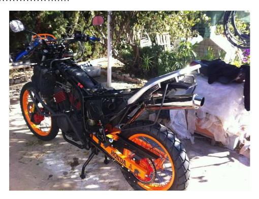
Para que la inclinación del colín siga la línea ascendente, le hacemos unos cortes laterales para doblarlo como una bisagra y lo fijamos a los mismos tornillos que sujetan el soporte de las alforjas al portabultos, dándole cierta separación mediante una tuerca interpuesta. Empalmamos el colín con fibra por su interior recuperando su integridad, para luego lijar y preparar para su pintura definitiva.
