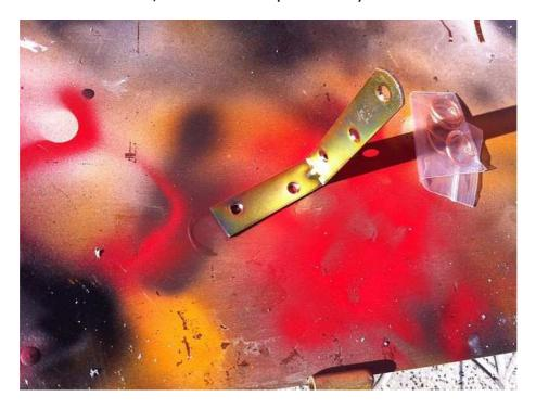
Una vez soldado al chasis, el portabultos ya tiene un anclaje totalmente sólido por su parte delantera. (Las pestañas quedan encajadas entre el soporte y las nuevas pestañas, por lo que el tornillo solo las fija y evita que se abran)
