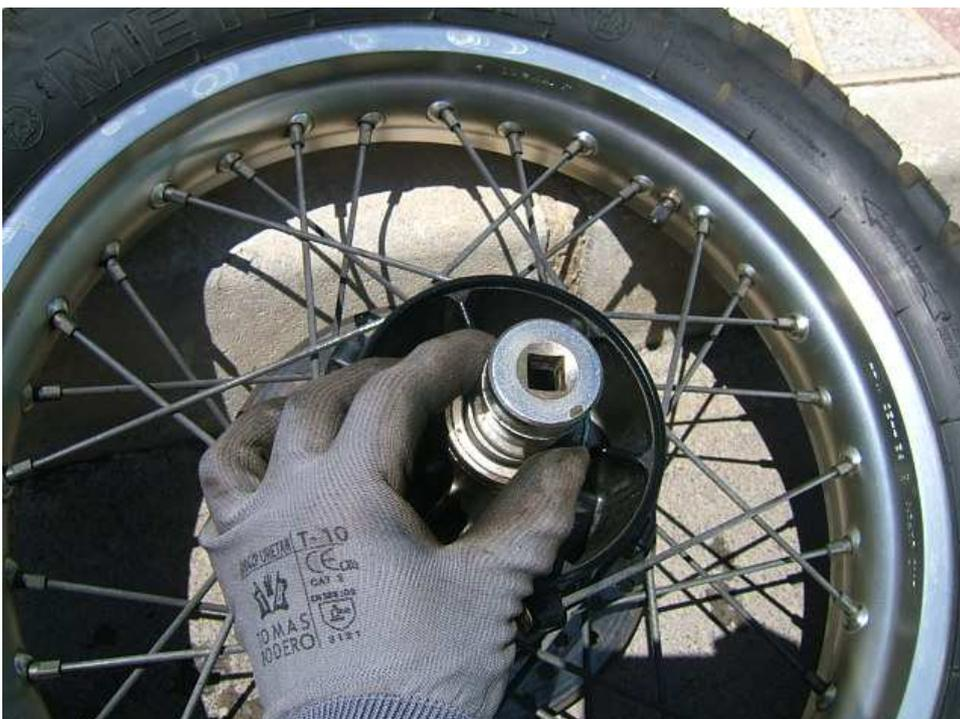
Una vez puesto el rodamiento, hay que embadurnar bien de grasa por ambos lados. No es para engrasar los rodamientos, que van sellados, sino para que no les entre agua o humedad:
