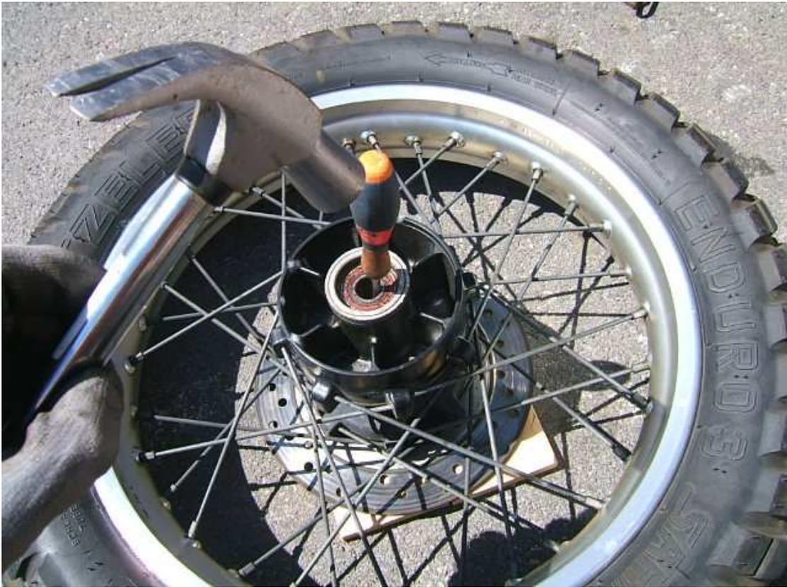
El rodamiento que se encuentra en el porta-coronas ha sido con diferencia el que más me ha costado sacar. En esta foto se ve la maza, el cincel, los tres rodamientos viejos, el separador que se encuentra entre los dos rodamientos de la llanta y que estaba totalmente oxidado, y abajo en la foto se ve un pequeño separador que hay que quitar del rodamiento del porta-coronas.
