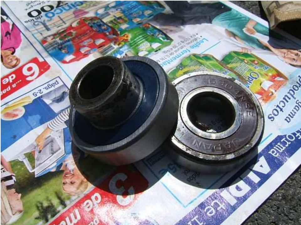
Para poner los rodamientos nuevos hay que golpear sobre el aro exterior de forma uniforme, nunca sobre el interior. Se puede utilizar el rodamiento viejo o una llave de vaso del mismo diámetro o apenas inferior al del aro exterior del rodamiento.
