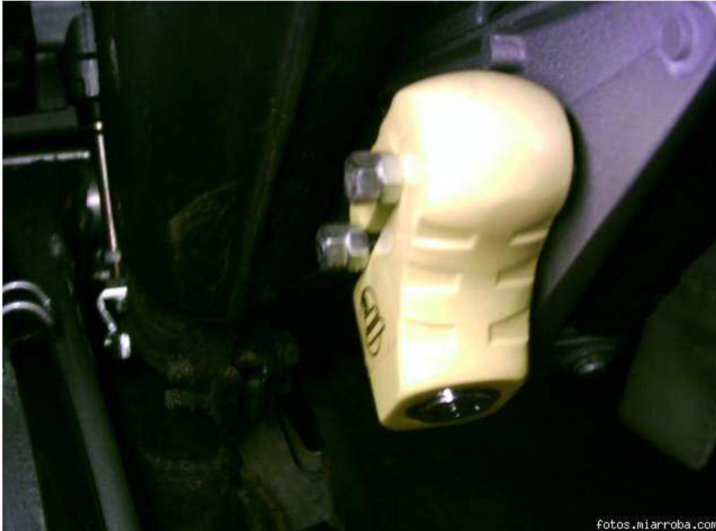
Finalmente le ponemos un poco de cinta aislante en los tornillos para las posibles vibraciones y le damos una manita de pintura del spray negro anticorrosivo que aun nos queda de pintar el escape del vespino del año 1990.
