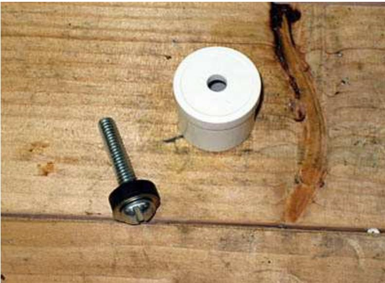
Perforar el centro de la tapa. He utilizado un tornillo de 1/4". Aquí es donde el tornillo de la máquina será colocado.
