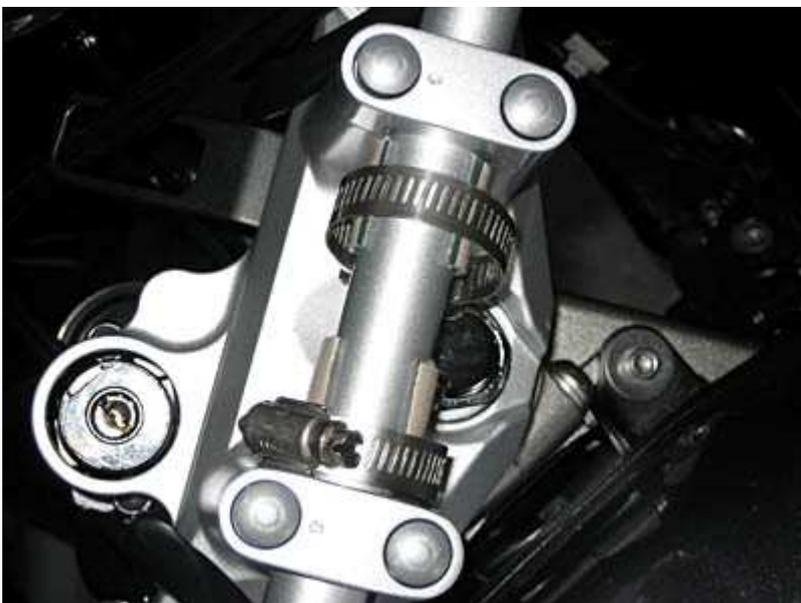
Desenrosque las abrazaderas de manguera hasta el fondo.
