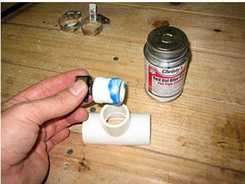
Pegue el casquillo de la pipa con el tornillo de la máquina en la parte superior del tubo T.
