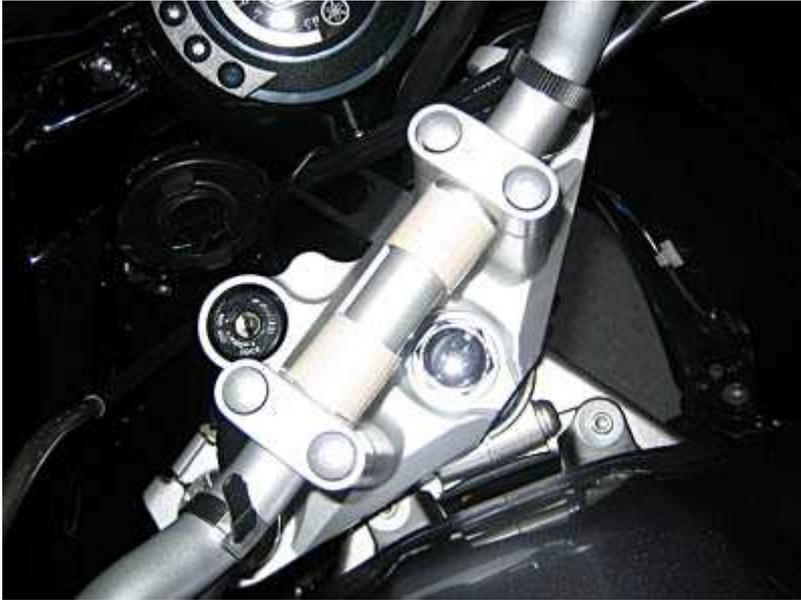
Envuelva sus secciones viejas de manguera de jardín en su manillar. Hice esto por tres razones: 1) para proteger el acabado del manillar de la abrazadera del dispositivo, 2) para ayudar a proporcionar un "agarre" para sujetar a la superficie, y 3) para tratar de reducir las vibraciones en el montaje en general.
