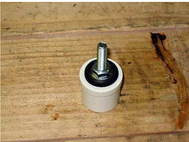
Montar tornillo para la máquina en el casquillo de la pipa. He utilizado una arandela plana en cada lado que aprietan directamente en el PVC. Es probable que pueda saltar las arandelas de goma, pero solo es para el aislamiento de vibraciones.
