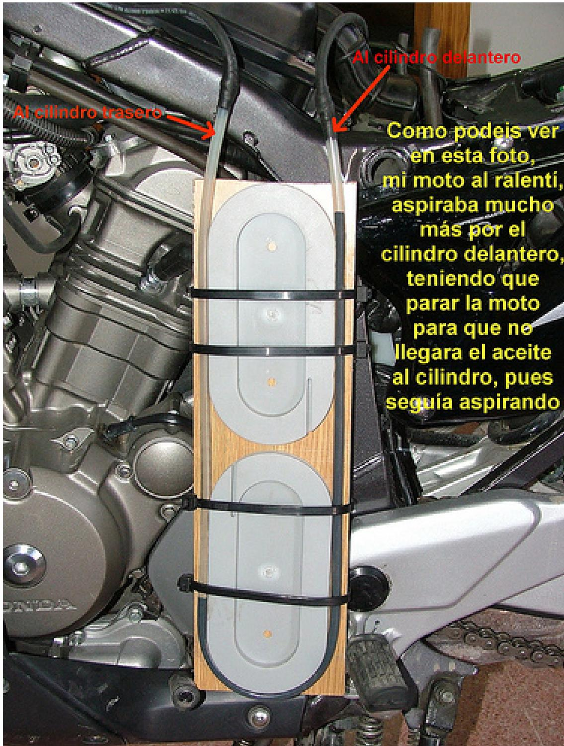
Así es que a ajustar tocan. Para ello, por el agujero que hay en el centro de la caja del filtro de aire y si miramos con una linterna, podremos ver allá abajo el dichoso tornillito del ajuste. OJO: necesitaremos un destornillador extralargo para poder llegar a él, los normales no llegan. De todos los que tenía a mi disposición (que son muchos) no me servía ninguno, y tuve que fabricarme uno martilleando una varilla de acero para hacerle un plano que entrara en la cabeza del tornillo.
