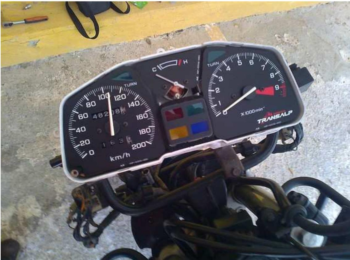
Luego solo tenemos que quitar los dos tornillitos que sujetan el velocímetro
