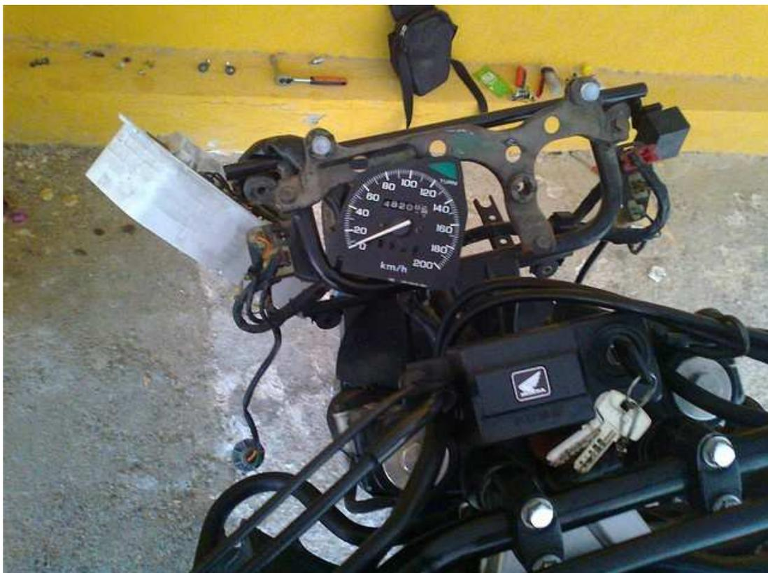
Entonces al mover la moto sin el velocímetro veo como el cable del velocímetro gira de forma irregular, lo desmonto, y noto que esta muy duro me cuesta hasta quitarlo, meto en el forro del cable aceite en cantidad y luego refriego el cable dentro para aflojar la grasa seca, vuelvo a engrasar y armo nuevamente, vuelvo a probar y esta vez si funciona como corresponde.
