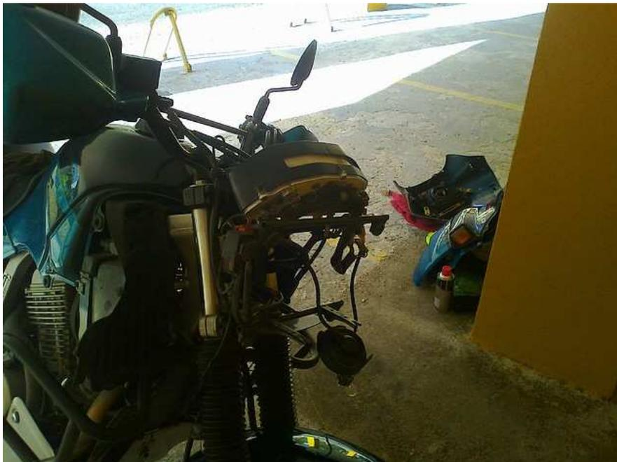
Lo siguiente fue quitar estos tres tornillos y soltamos el cable del velocímetro para poder soltar el tablero de instrumentos y así llegar a los del velocímetro
