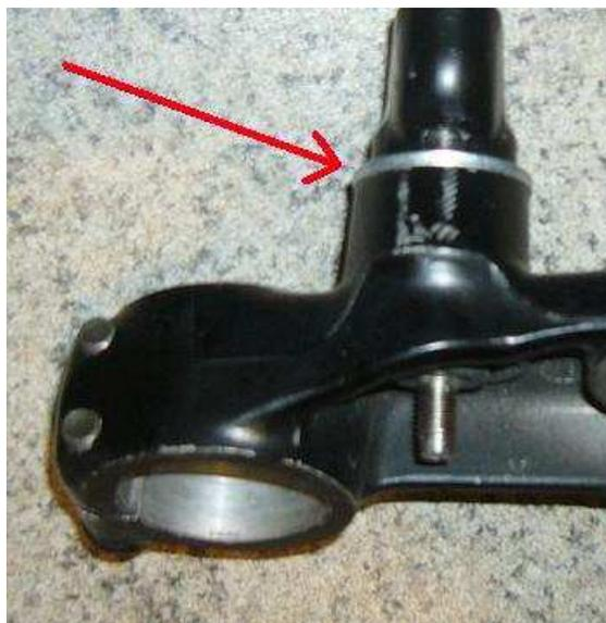
se meten nuevamente en la placa los dos soportes y se encajan las arandelas debajo de la placa, arandelas originales (absolutamente necesario en la placa) y así, se aprieta y el trabajo está hecho.
