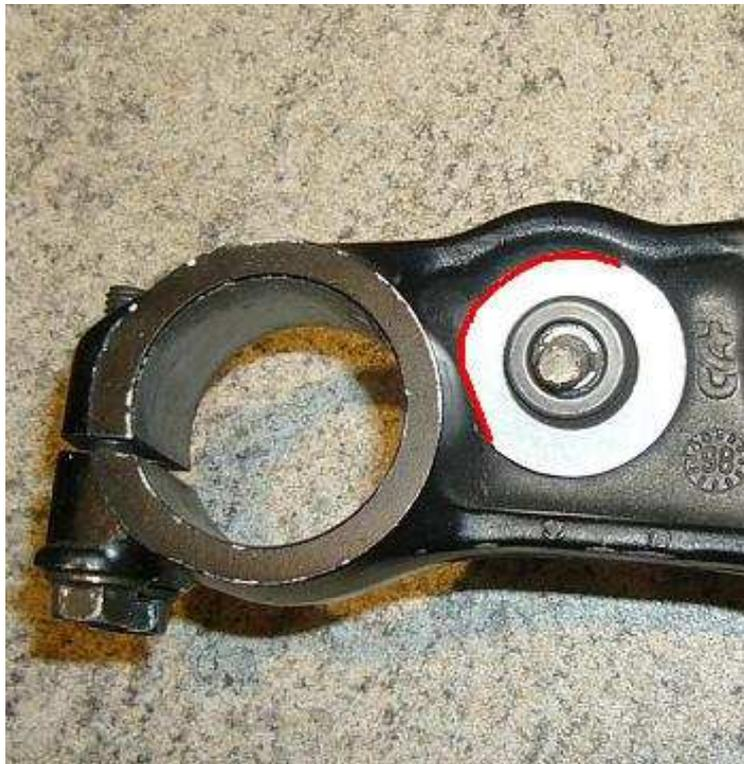
En las dos arandelas bajo la placa cuando el diámetro exterior superior a 32 mm. Se harán dos biseles (marcados en rojo en la imagen) para situarse a la derecha y hacia la parte trasera de la moto no sería capaz de poner y no ir a golpear correctamente.
