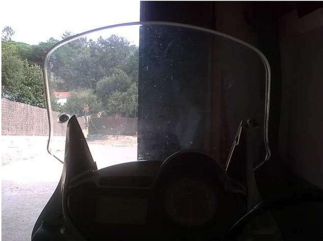
He utilizado los mismos tornillos que traía, solo necesitaras un par de tuercas (autoblocantes por aquello de las vibraciones) con dos arandelas de 4 mm. Esta tarde volviendo de Gerona, tengo que hacer unos 15 Km. de autovía y a 120/130 Km/h han desaparecido esos molestos golpes de aire que llegaban antes. Y a menos velocidad increíble, supongo que con la abertura de la pantalla crea un vacío que evita que te lleguen los golpes de aire al casco..... Ole. Ole.
