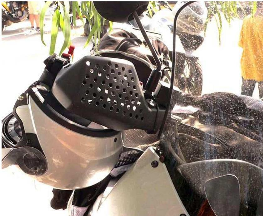
Como brico-detalle en esta última foto también podemos observar el mecanismo para variar la inclinación de la cúpula con tres simples taladros a cada lado y un par de tornillos.
