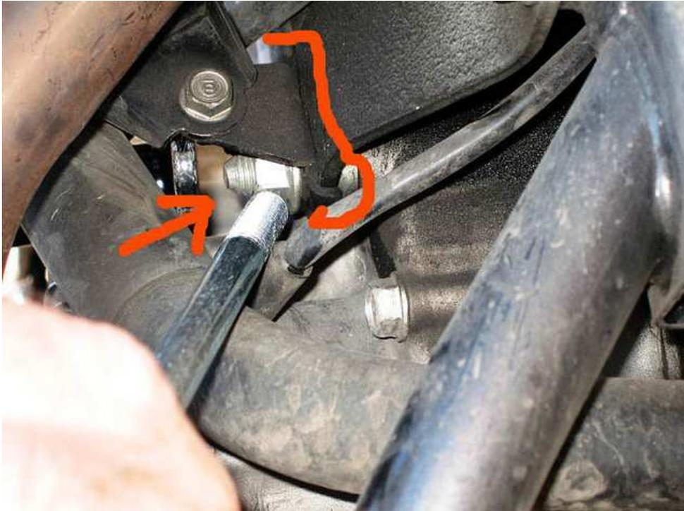
**Fase 3:** sacar los tornillos (llave de tubo de 10) que sujetan la araña por abajo junto a los soportes del motor. **MUY IMPORTANTE:** Fijarse bien como se sujetan pues tienen unas aletitas que han de colocarse igual, es la marca vertical de la foto de encima (No te das cuenta hasta el final, si lo haces mal, y hay que aflojarlo todo de nuevo). *Tiempo: 10 minutos*
