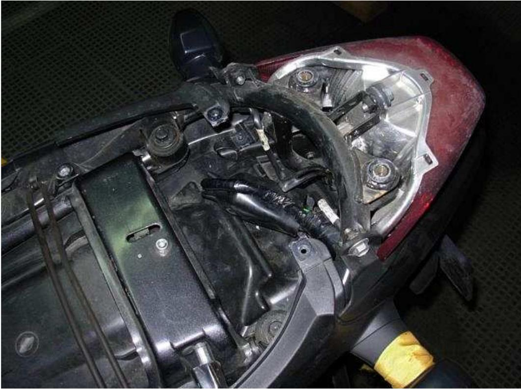
Después de colocar otros dos tornillos en la parrilla de la maleta para hacer la conexión con la maleta, estañamos un poco los tornillos para hacer mejor contacto.
