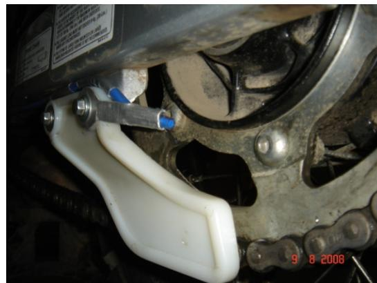
Montando y cortando el excedente de salida en guía de Grilón.
