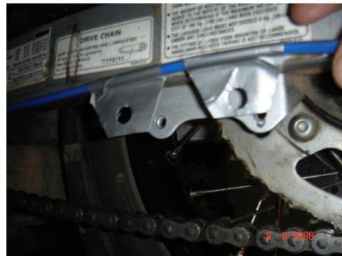
Fijando con cinta TAPE 3M atrás del guarda cadena de Grilón.
