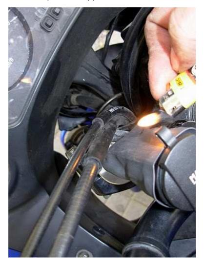
Truco: tener 2 mecheros, para no quemaros los dedos. Insistir con el calor e ir encajándolo bien. Ojo con el mechero, separar bien el resto de cables, no tengamos luego problemas. Al final, aunque parezca que no, se queda d'abuten
