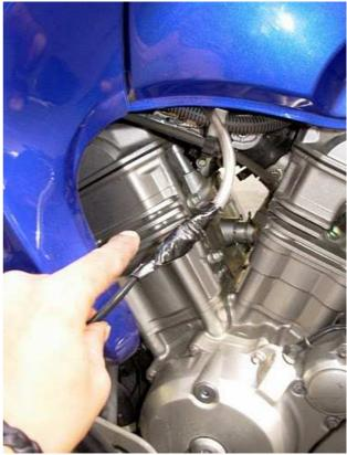
IMPORTANTE: Una vez hayáis sacado los cables por el manillar, poner enseguida el plástico maleable al calor que viene con el Kit sino luego os olvidaréis.
