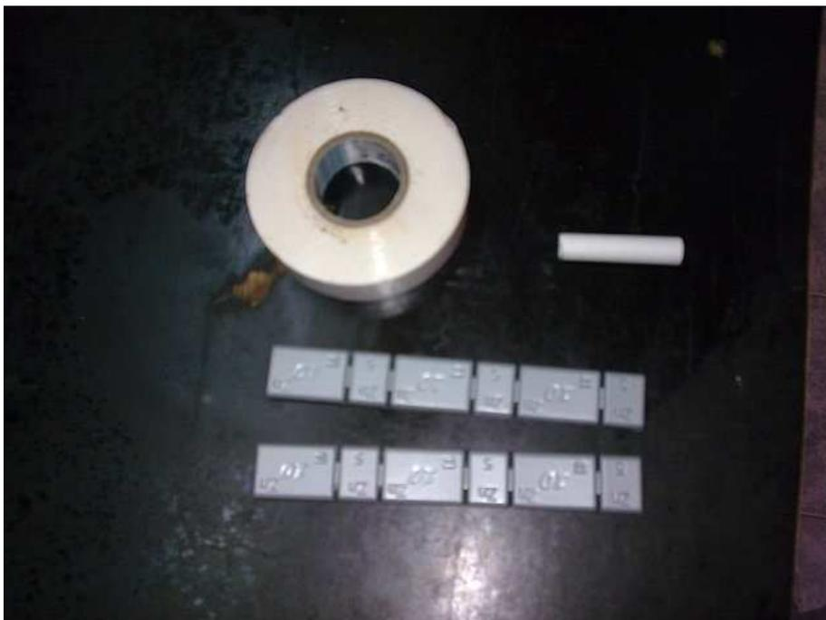
Le damos un poco a la rueda para que gire, con poco vale si no queréis estar una hora esperando que se pare, cuando se pare del todo marcamos con una tiza la parte mas baja, que será lógicamente la parte que mas pesa de la rueda, por lo tanto el plomo lo pondremos en el lado opuesto.
