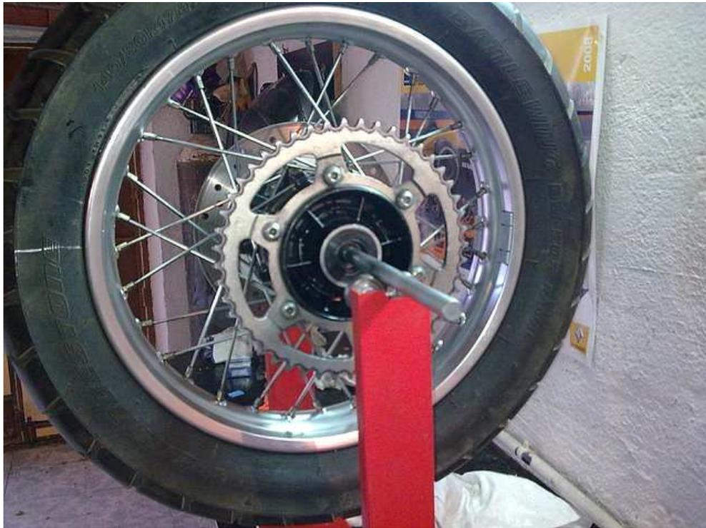
Como no sabemos el peso que debemos colocar, ponemos la rueda como esta en la foto y pegamos la tira de plomo con la cinta aislante, si el plomo se va hacia abajo nos sobra peso, si por el contrario se va hacia arriba nos falta peso, así iremos poniendo o quitando según proceda hasta que demos con el peso ideal y la rueda no se mueva. La hacemos girar un par de veces y si la rueda esta bien equilibrada cada vez se parara en un sitio distinto.
