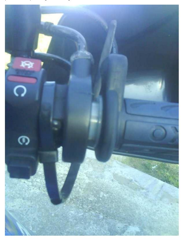
En esta otra foto el control de crucero está "activado". La brida se queda "pillada" entre el puño del acelerador y el tamborcillo donde se alojan los cables del acelerador.
