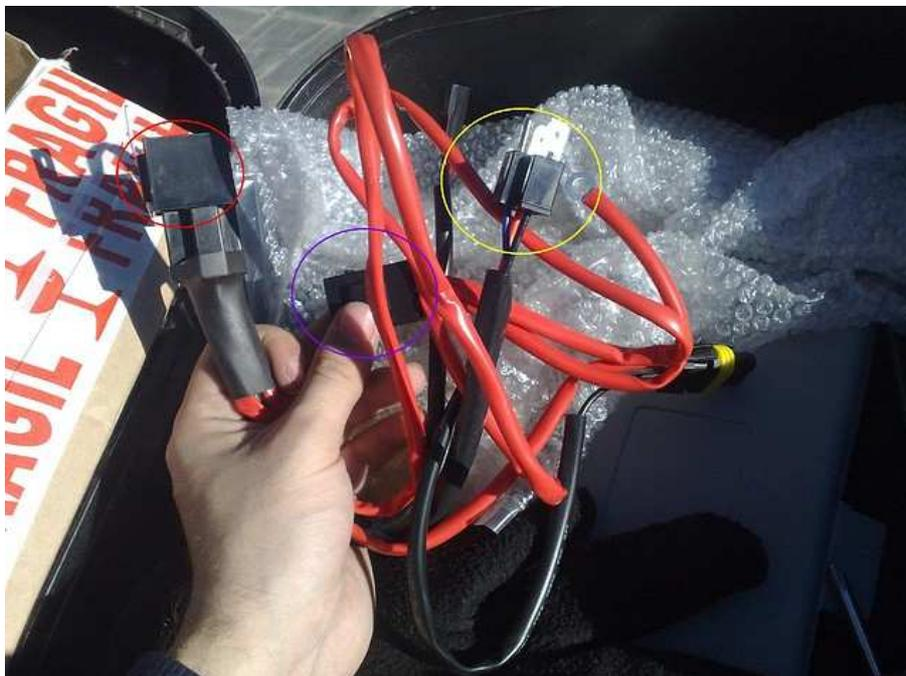
Aquí vemos otra parte del cableado. NO TODOS LOS KITS VIENEN IGUAL Y TRAEN ESTO. En rojo vemos el Relay, en Violeta el fusible, y en amarillo el macho H4 de 3 patas que va donde se enchufa la lámpara original de la moto.
