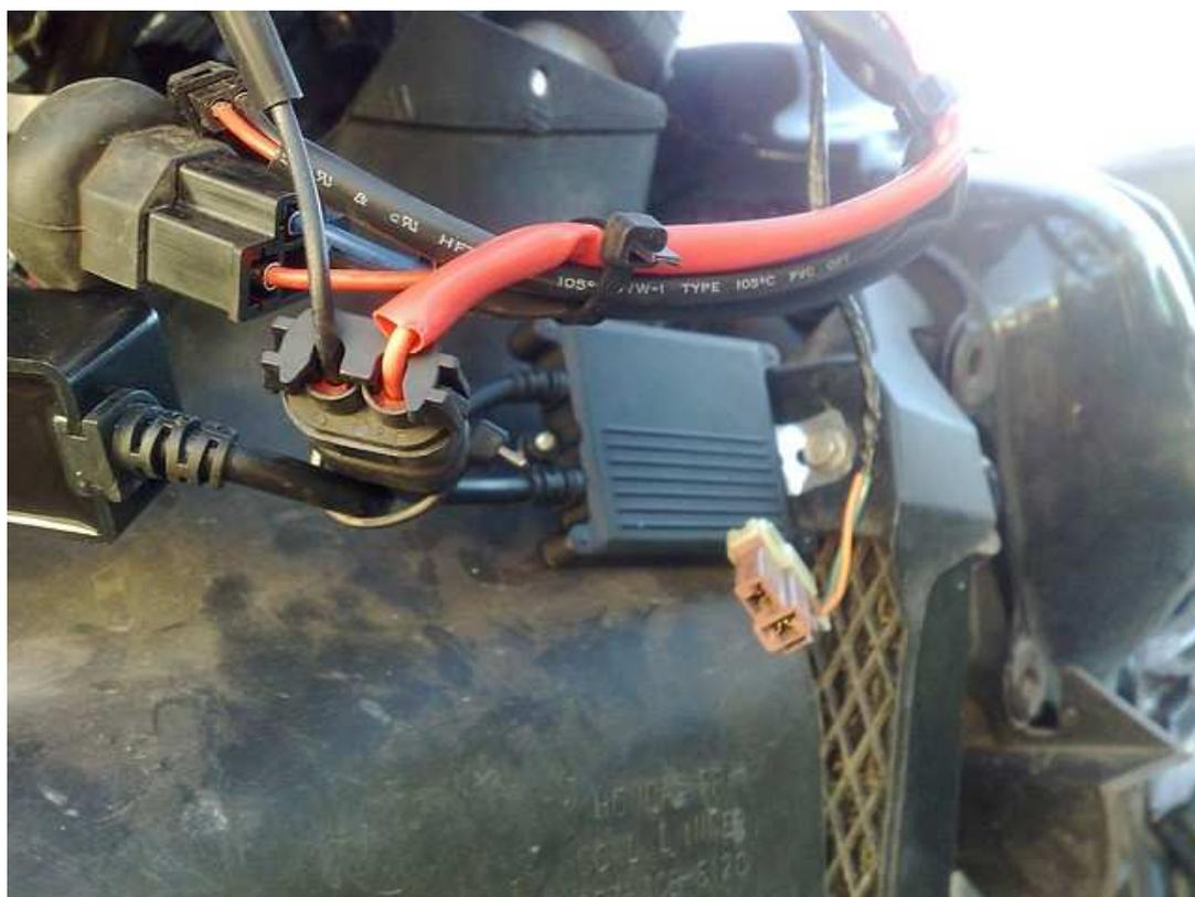
**Ya casi armado, una vista del relay del sistema "encajado" en el soporte de los intermitentes.**
