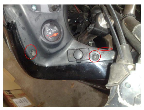
Solamente lo "despegamos" un poco, no es necesario desmontar todo. Luego a desenganchar el carenado lateral tirando de la toma de aire despacio, cuidado con los tetones (2), no romperlos. Recordar sacar antes el tornillo Allen de abajo.
