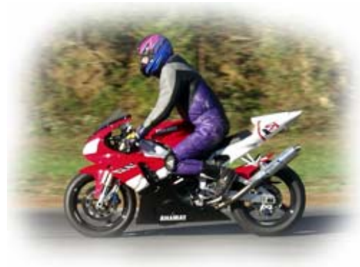
Fig. 2: Al accionar la maneta del freno, la moto comprime el amortiguador delantero al tiempo que descomprime el trasero.
