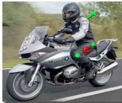
Fig. 5: Durante la frenada, la presión sobre las rodillas, contiene la inercia del piloto, y permite incorporarse de la moto, sin cargar de peso el manillar.
