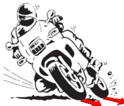
Fig. 7: Durante la tumbada, los neumáticos sufren una fuerte carga lateral, que alcanza su máxima expresión justo antes de la aceleración
